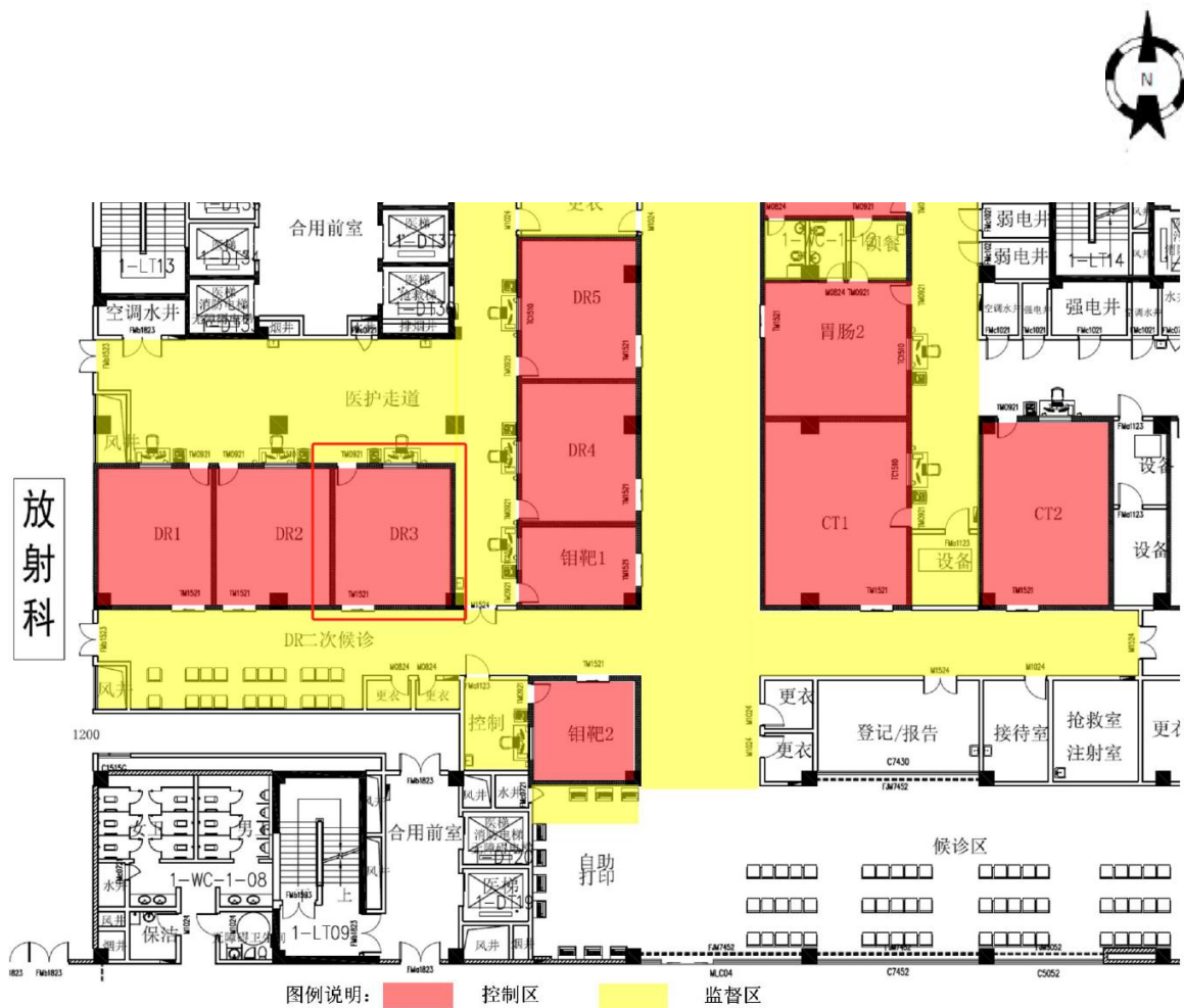
图 3-11 门诊医技楼一层放射科（DR 机房 3）平面布局图
